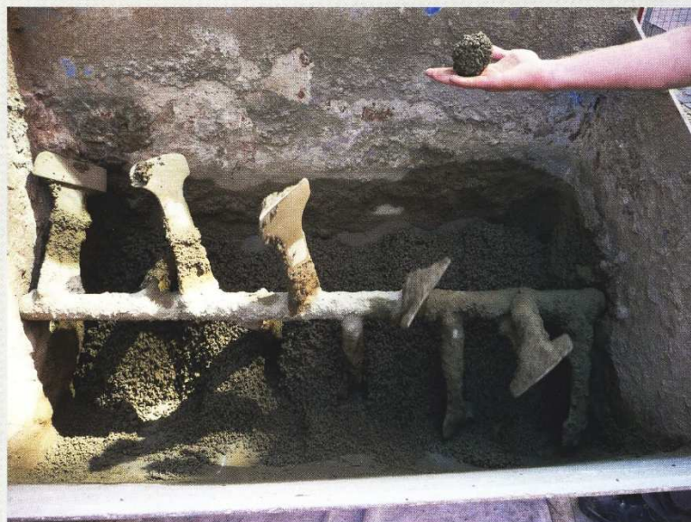
Bild 1: Schneeballversuch zur Konsistenzbeurteilung von Bettungsmörtel
